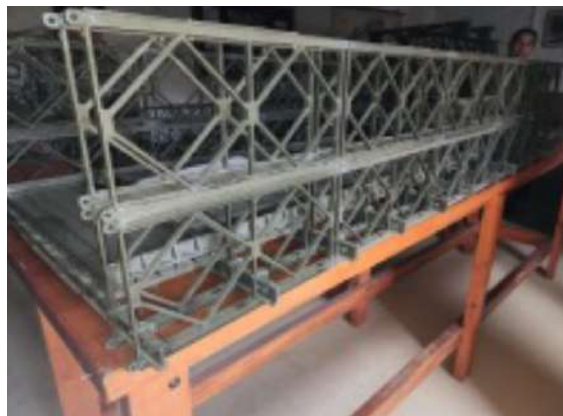
Figura N° 5: Escala del puente Bailey. Fuente: Escuela de Ingenieros (2024).
