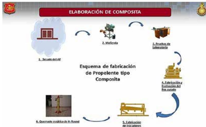
Figura N° 14: "Esquema de fabricación de propelente tipo composita"
