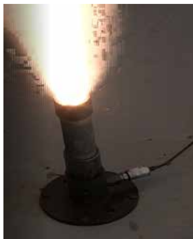
Figura N° 18: "Quemado de K-Round en un banco estático de pruebas".
