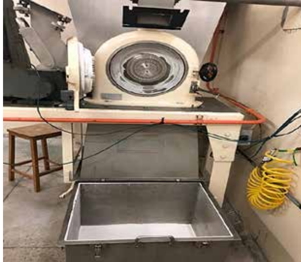
Figura N° 16: "Molino Eurotherm tipo dispersión".
