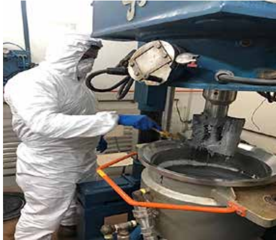
Figura N° 17: "Instrumento de mezclado para la producción del propelente".
