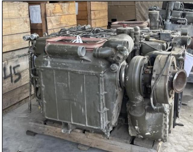
Figura N° 15: Motor de tanque Leopard 2 A4.
