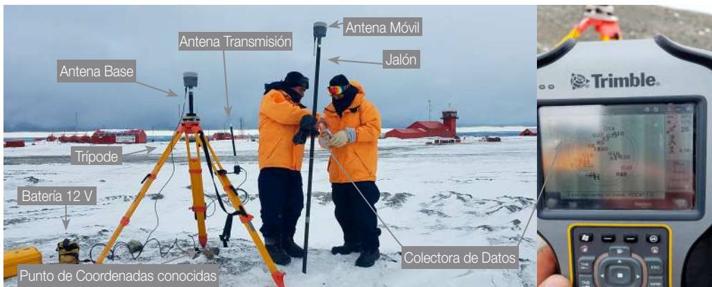
Foto N° 6: Vista de la base, móvil (o Rover) y colectora de datos.
