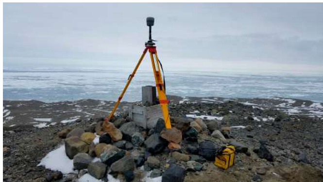
Foto N° 4: Posicionador geodésico GNSS marca Trimble modelo R10. Fuente: Elaboración propia.
