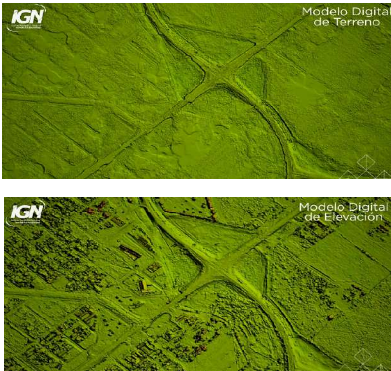
Figura N° 5: Modelo Digital de Elevaciones y Modelo Digital del Terreno.
