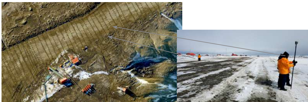
Foto N° 8: Recorrido transversal de la antena móvil para realizar el levantamiento. Cada punto amarillo es donde se ubica el jalón de la antena móvil para obtener sus coordenadas (x, y, z).
