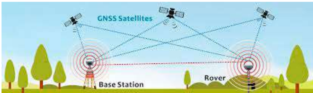
Figura N° 4: Base Station (Estación Base) / Rover (Móvil) / GNSS Satélites (Constelación Satelital).
