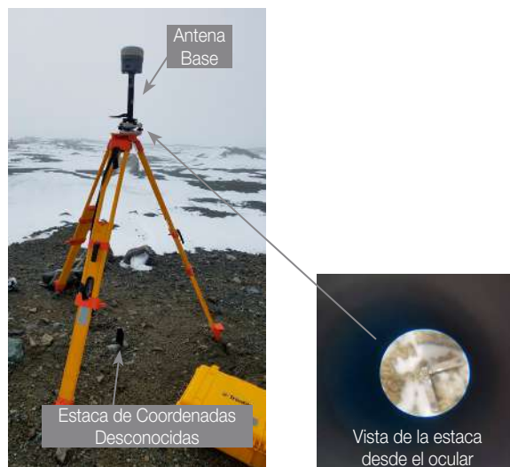
Foto N° 5: Antena base sobre una estaca de metal.
