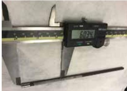
Figura N° 17: "Pie de metro digital y calibrador de avance de cono".
